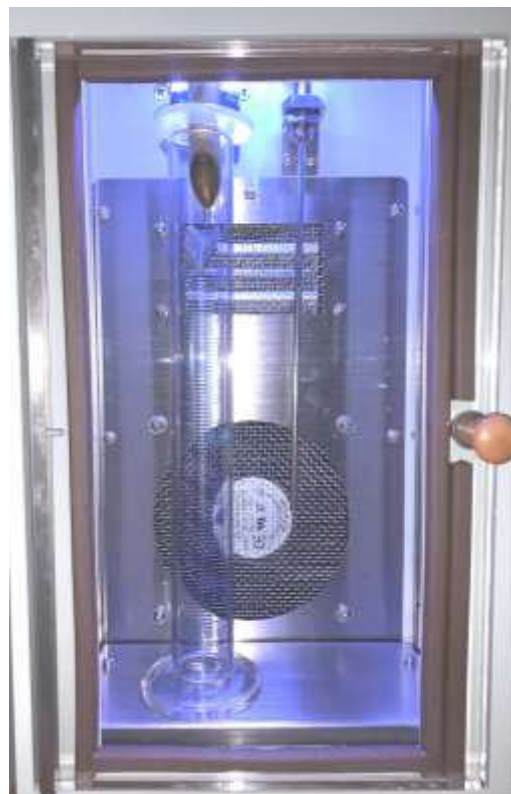
Рис. 5. Приемное отделение АРНП-К-ПХП с цилиндром и подсветкой
